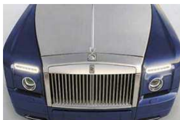
Afbeelding 6: AISI304 motorkap behandeld met Polinox Protect na vier jaar gebruik.
