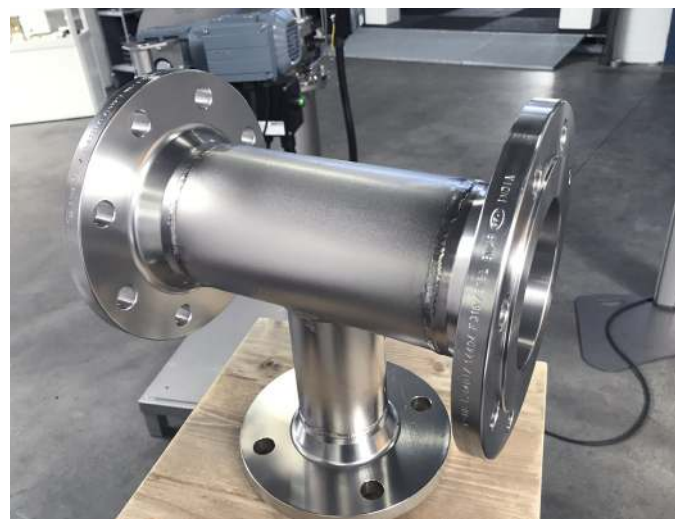
Afbeelding 1: roestvast staal piping component behandeld met PureFinish natstralen (foto Innomet b.v.).
