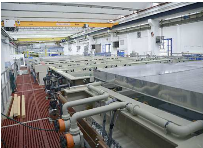
Afbeelding 11: bad van 6 x 2 x 2 meter voor de Polinox Protect behandeling (bron Poligrat).
