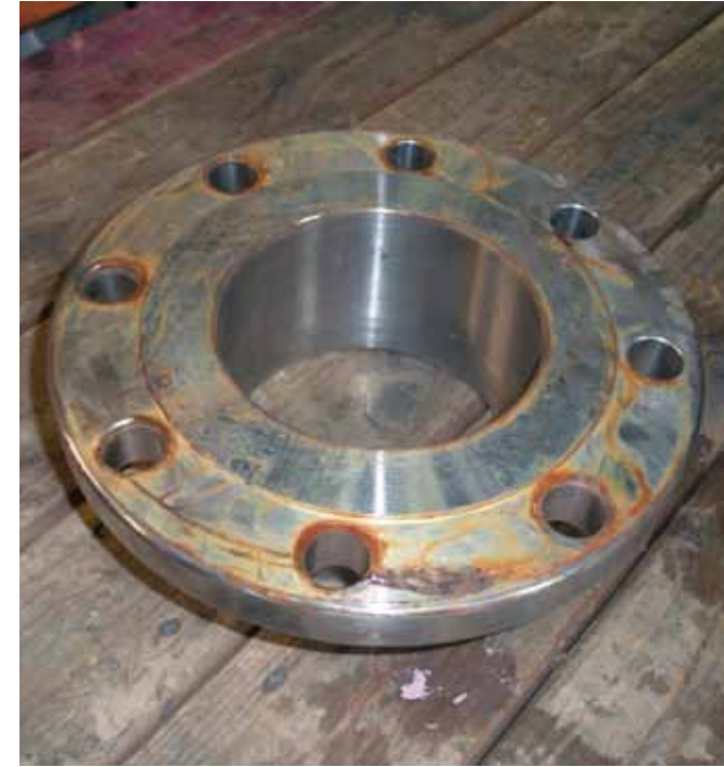
Roestvast staal flens van 304L voor en na de behandeling met Innosoft B570 (foto's Innomet b.v.).
