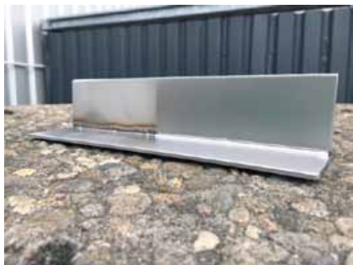
Afbeelding 4: De rechterhelft is behandeld met het PureFinish proces (foto Rösler).
