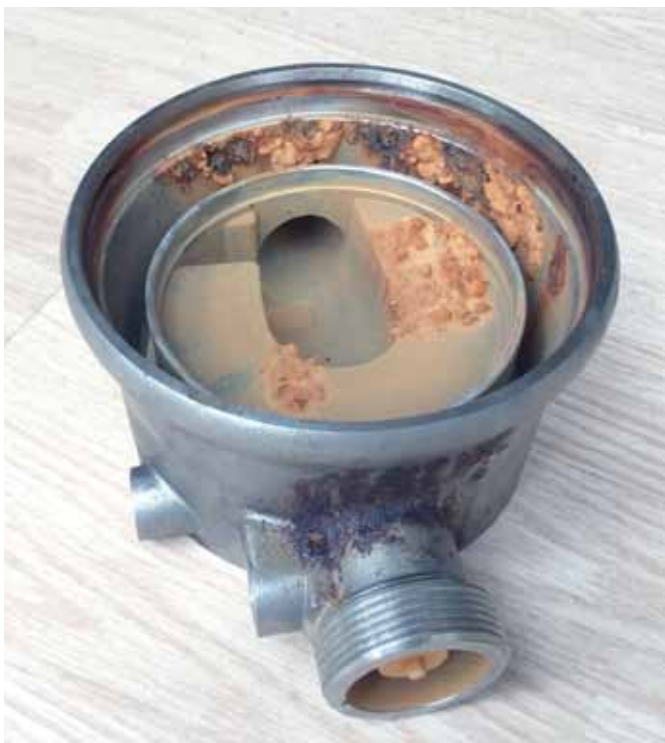
Afbeelding 1: een pompvoet van roestvast staal AISI 304 aangetast door MIC (foto Innomet b.v.).
