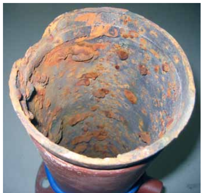
Afbeelding 2: Stalen aangetaste 4"pijp door MIC (foto MIC Europe b.v.).
