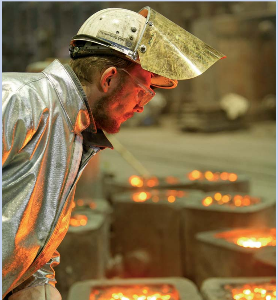
Het verwerken van nikkel tot legeringen bij ThyssenKrupp. Nikkel wordt veel als legeringselement gebruikt in voornamelijk ijzer- en koperlegeringen (foto: ThyssenKrupp/Inoxum)
