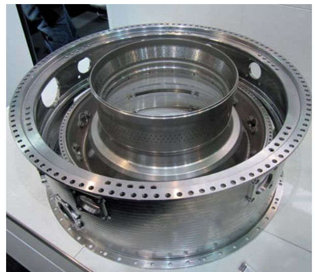
Nikkel wordt gebruikt bij de productie van roestvast staal en hoogwaardige nikkellegeringen. Op de foto een compressorhuis van CrNi-staal zoals door DMG getoond tijdens de AMB 2010. Dit is een werkstuk voor aerospace toepassingen met een diameter van 700 mm dat in 17 uur en 20 minuten verspaand is (foto: Reinold Tomberg)
