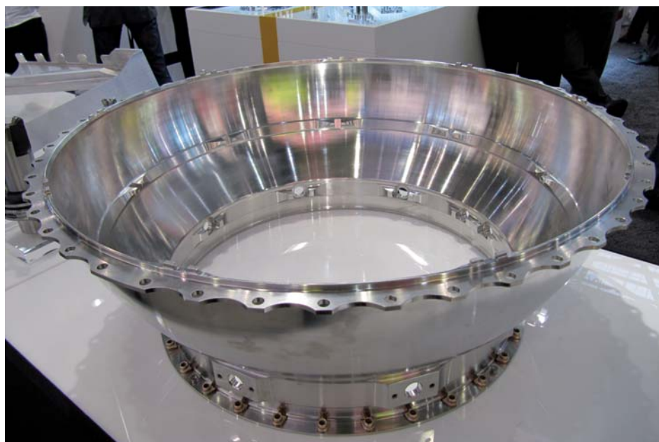
Een turbinehuis van de legering Inconel 718 getoond door gereedschapsleverancier Walter tijdens de AMB 2010 (foto: Reinold Tomberg)
