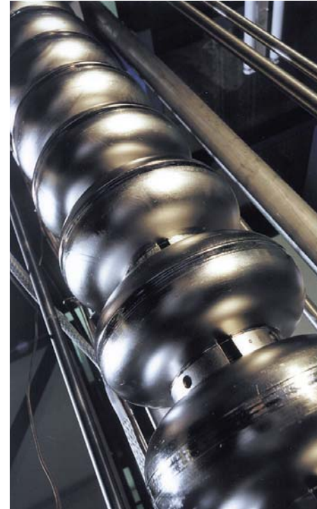
Een supergeleidende resonator gemaakt van 100% puur niobium. Deze resonator wordt ingezet voor het versnellen van elektronen (foto: Desy)
