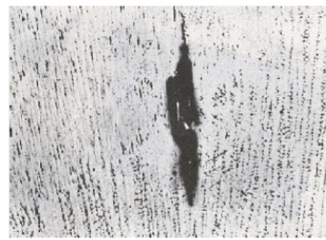
Afbeelding 1: warmscheur ontstaan op de grens van twee austenietkristallen.
