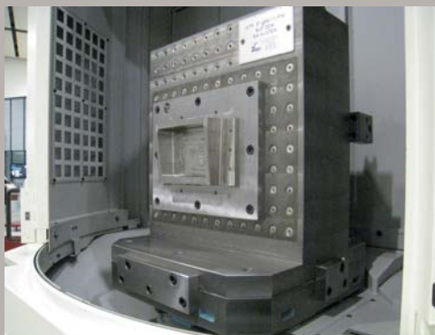
Een blok titaanlegering TiAl4 vorig jaar tijdens een verspaningsdemonstratie bij Makino. Het blok werd bewerkt met een spil met een koppel van 1000 Nm (15% inschakelduur) (foto: Reinold Tomberg)
